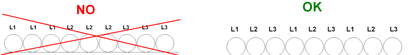
Рис. 9 – Монтаж длинных проводов электропитания
